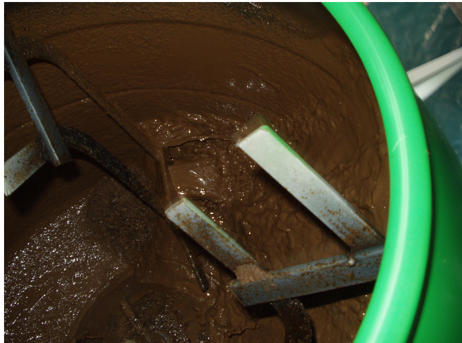
Foto 2 – Particolare della miscelazione del terreno e del gasolio
