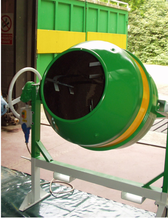
Foto 1 - Miscelazione del terreno e del gasolio per l'omogeneizzazione della contaminazione
